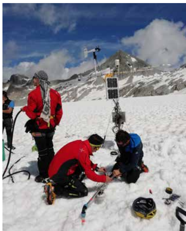
Operazioni di settaggio di una stazione di misurazione automatica, in collaborazione con il Comitato Glaciologico Lombardo (© Cristian Ferrari)
